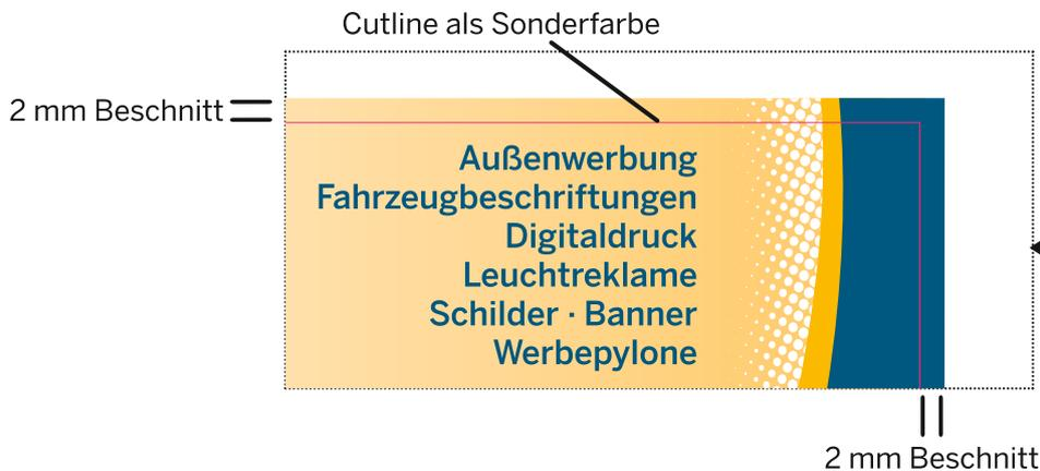
Anwendung: Folienschnitt im Digitaldruck im Print&Cut-Verfahren
